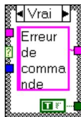
En sortie de la fonction de balayage, les éventuelles erreurs sont signalée dans une structure de type cluster. La variable booléenne de ce cluster est extraite pour tester la conformité au format recherché.
