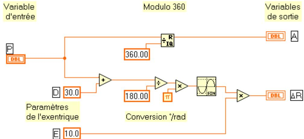
➤ Modifier si nécessaire les options de LabVIEW pour voir sur le diagramme des points aux jonctions de fils ( outils>>options – diagramme).
