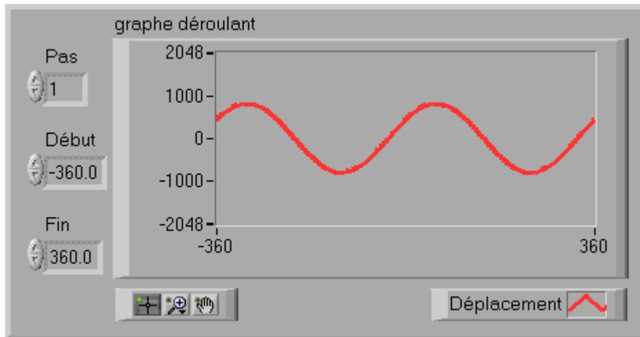
La boucle While itère depuis la position de début jusqu'à la position de fin. Les positions exprimées en degrés devront être au préalable converties en nombre de pas (.../1.8).
